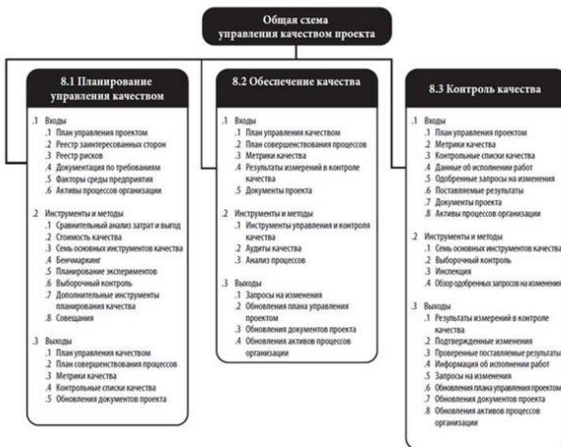
Рисунок 6.1 – Общая схема управления качеством
