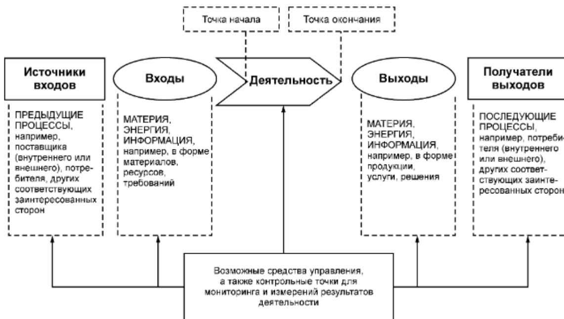
Рисунок 3.1 – Схематическое изображение элементов процесса по ГОСТ Р ИСО 9001-2015
