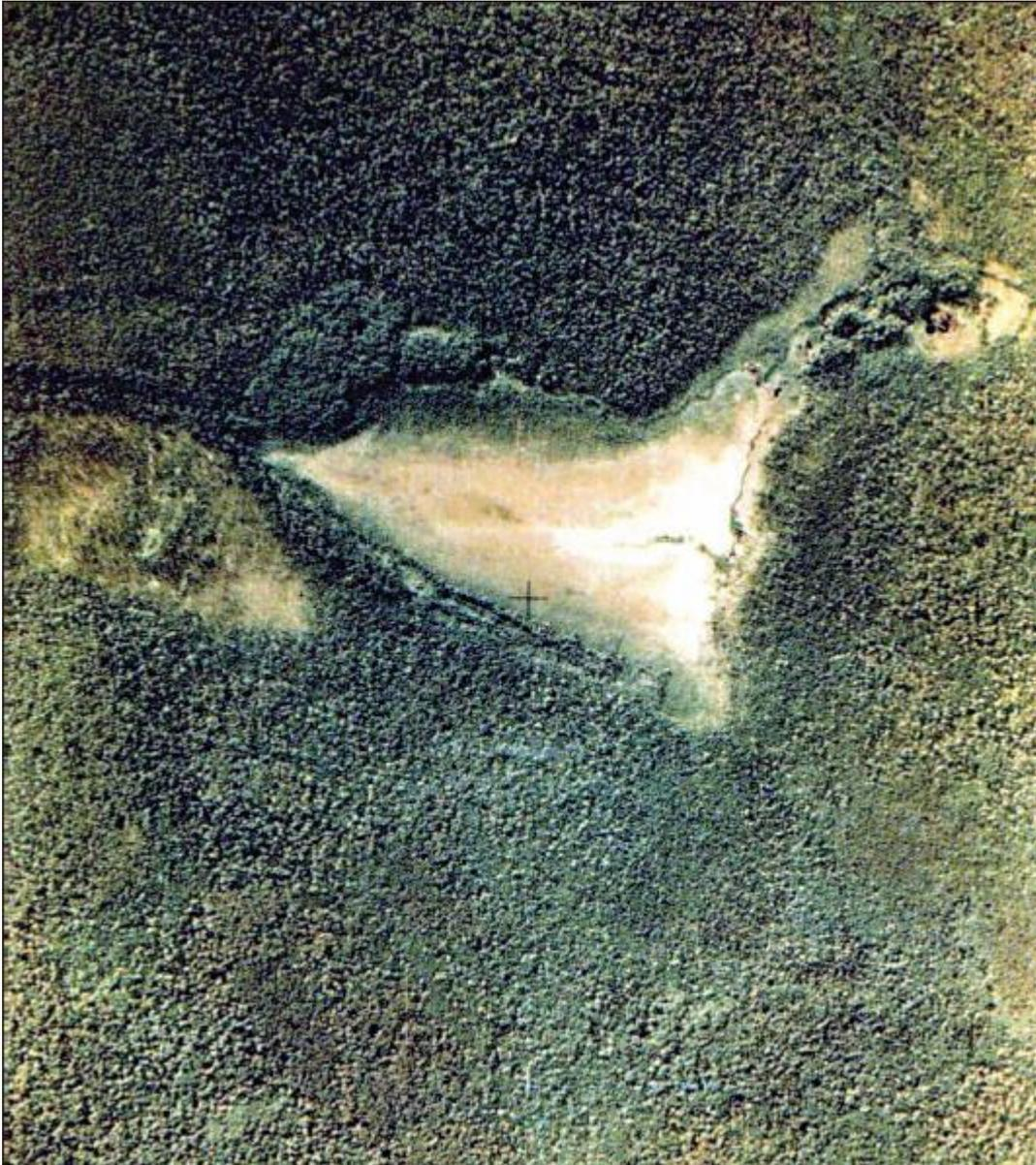
Рис. 2. МАС наледи Подпитка наледи осуществляется за счет притока вод из карстовой воронки (темное пятно в верхней правой части снимка), в днище которой отмечен выход подземных вод по тектонически обусловленной трещине. В данном случае и карст, и наледообразование связаны с тектонической трещиноватостью.
