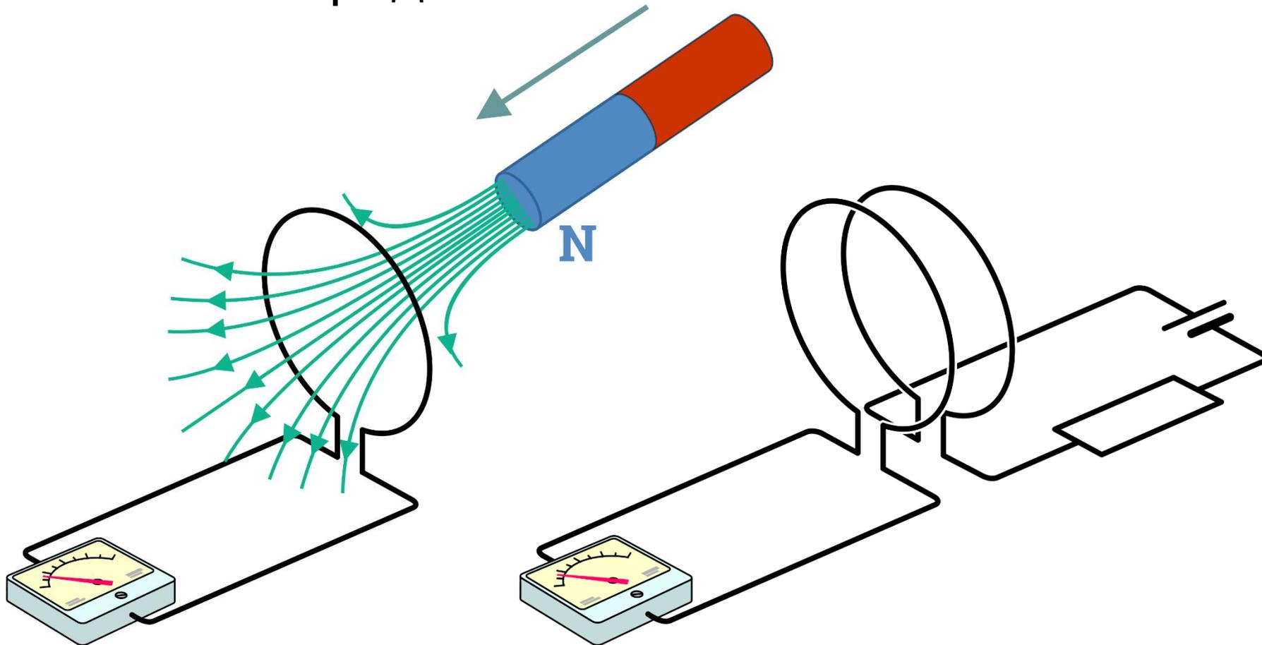
Значение индукционного тока совершенно **не зависит от способа изменения потока магнитной индукции**, а определяется лишь скоростью его изменения
