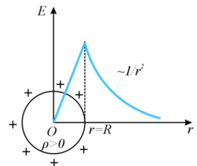
**Рис. 14.** Поле заряженного шара
