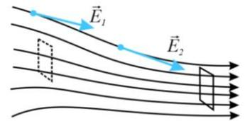
Рис.3 Линии напряженности неоднородного поля
