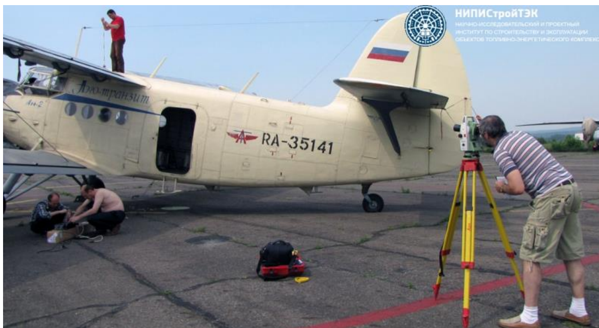
Установка аэросъёмочного оборудования на самолет АН-2, измерение офсет параметров
