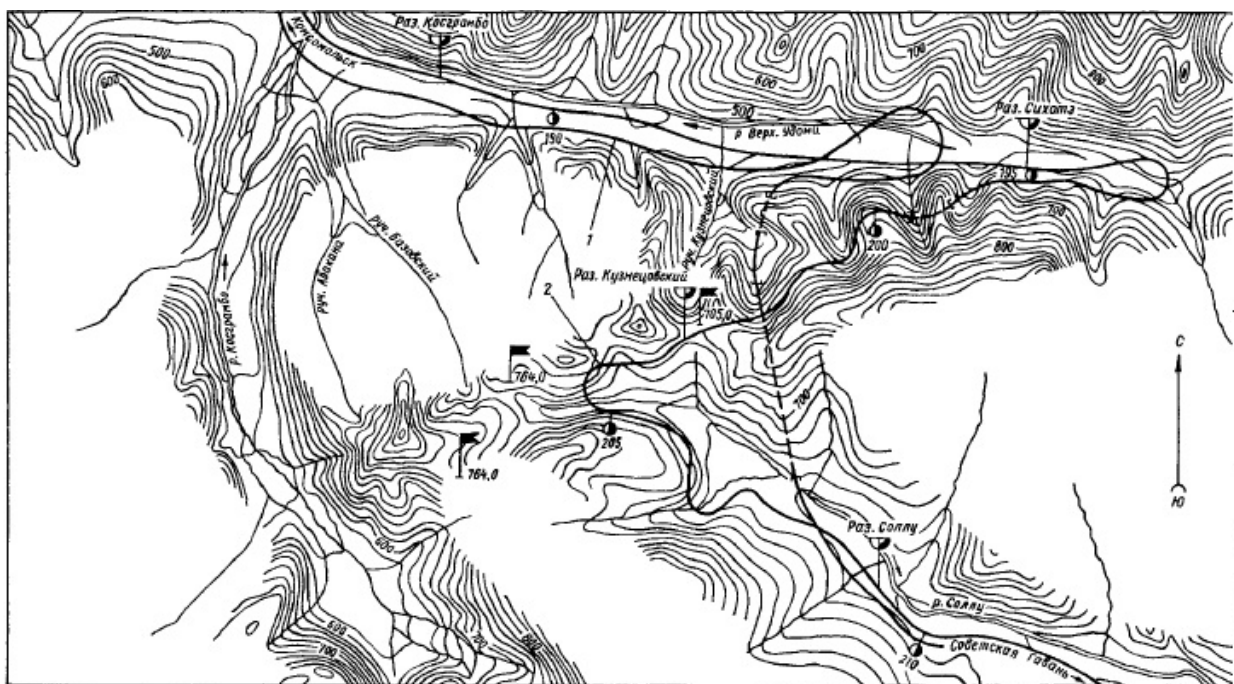
Рис. 4.33. Схема пересечения хребта Сихотэ-Алинь трассой варианта 1939 г. (1) и долговременным обходом 1943 г. (2)
