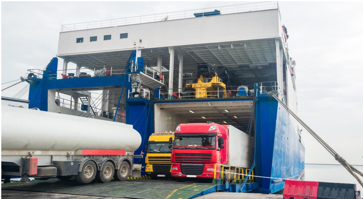
Рисунок 2 – Ролкер – судно с горизонтальным способом погрузки-выгрузки
