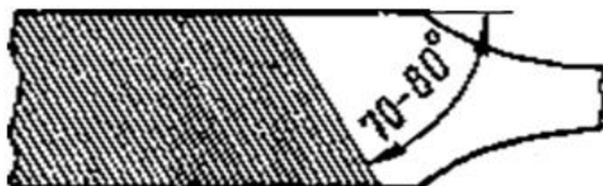
Рис. 6.3 Напильник с одинарной или простой насечкой
