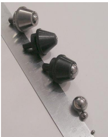
Рисунок 1.2 Шарики (инденторы) для проведения испытаний по Бринеллю
