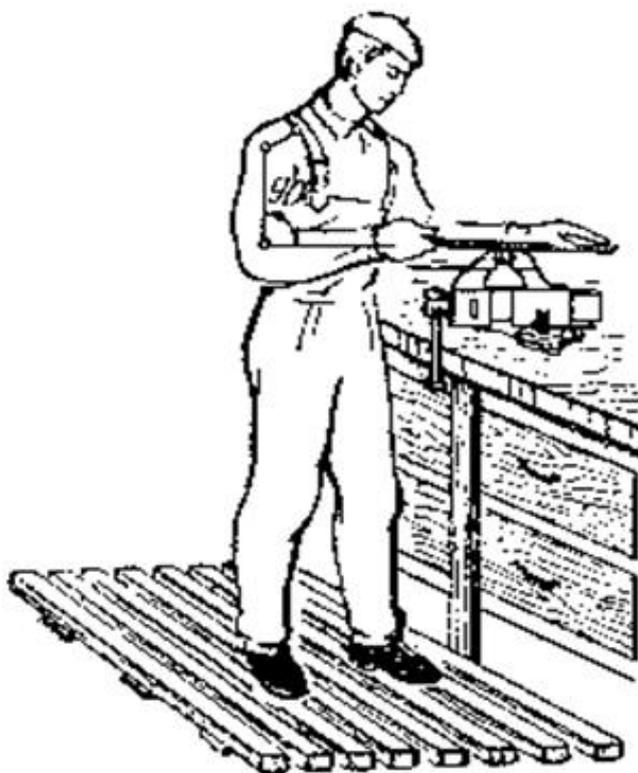
Рисунок 93. Положение корпуса работающего при опиливании
