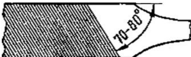
Рисунок 81. Напильник с одинарной или простой насечкой
