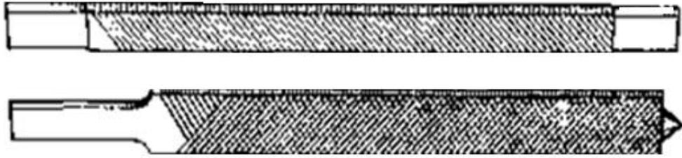
*Рисунок 87. Стержневые машинные напильники.*
